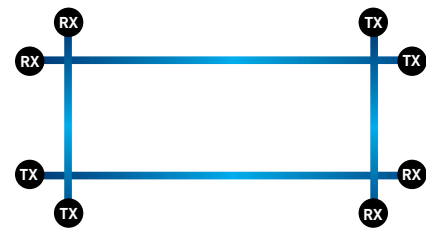
Protezione perimetrale 4 lati
